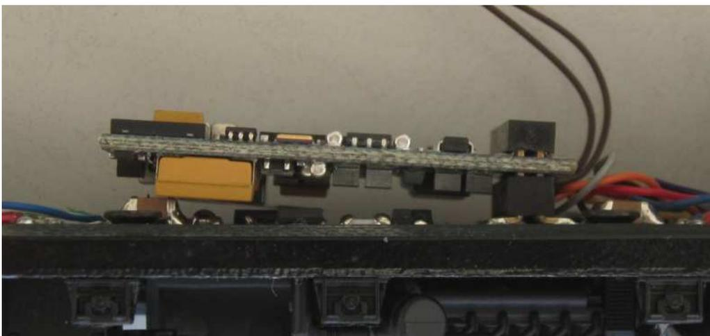
Der leichte Winkel, in dem der Decoder auf der Steckleiste sitzt sollte bei einmaligem Einsetzen auch hierfür kein Problem darstellen.
