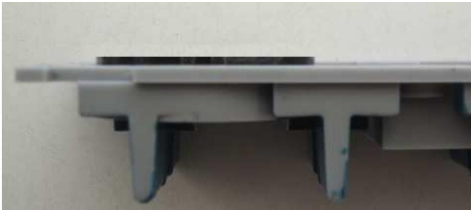
Hat die Soundkapsel die richtige Höhe, kleben Sie diese mit Sekundenkleber in die Abdeckung der Decoderschnittstelle. Achten Sie hier bitte darauf, dass sich die Schlitzpaare für die Lautsprecherkabel auf der oberen Seite (also der nicht verklebten) befinden und eines der drei Schlitzpaare in Richtung Decoder zeigt.
