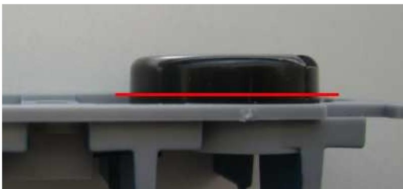
Jetzt kürzen Sie die Soundkapsel am besten mit einem PROXXON Bohr- und Fräßgerät MICROMOT mittels Trennscheibe oder aber mit einer feinen Säge. Eine Bearbeitung mit Messer o.ä. Gegenständen gestaltet sich schwieriger, da das Material der Soundkapsel relativ hart ist. Wenn die Kürzung ohne optimales Werkzeug erfolgt, kürzen Sie in diesem Schritt lieber etwas weniger und feilen Sie die Kapsel anschließend auf das gewünschte Maß.
